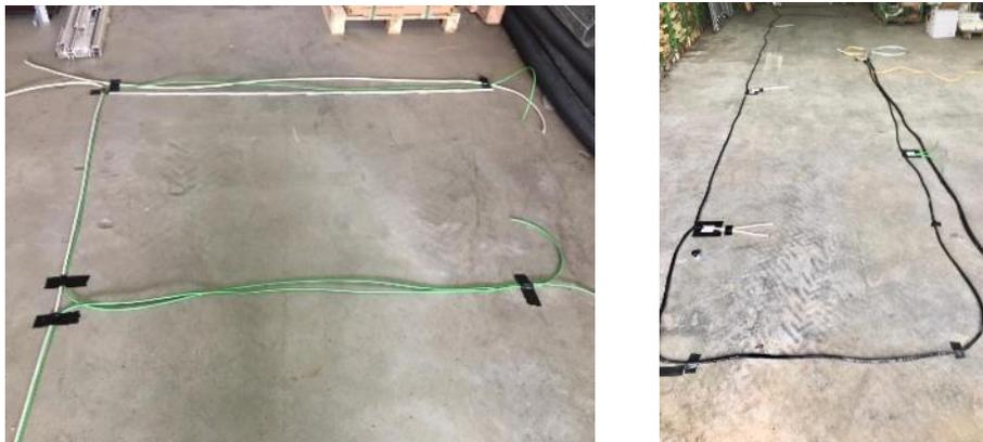
**Abbildung 11: Kabelstranggestaltung lose und gebündelt (v. l. n. r.)**
