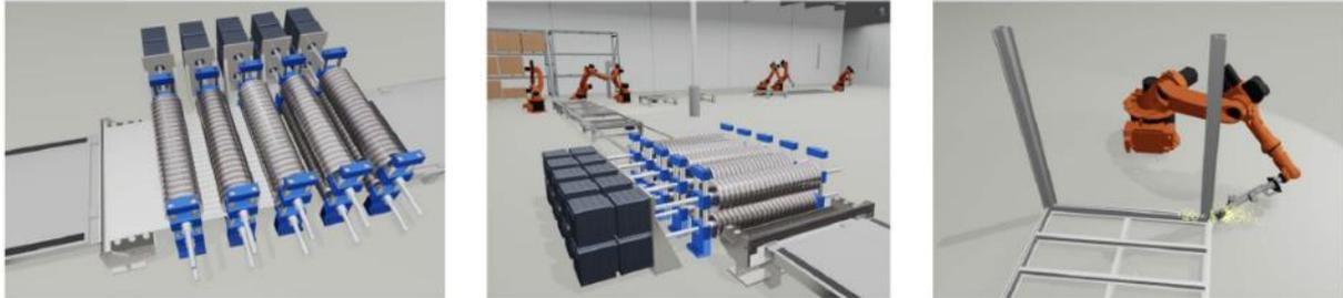
**Abbildung 9: Abbildung der Benutzeroberfläche des Virtuellen Zwillings am Beispiel einer Fertigungskette mit einer Walzanlage und einem Schweißprozess**
