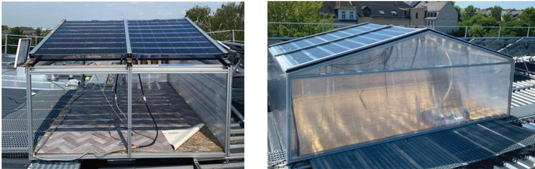
Abb. 7: Versuchsstand zur Erprobung der PVT-Kollektoren
