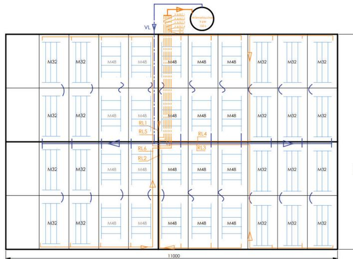
**Abb. 16: Medien- und Verlegeplan für die installierten PVT-Module**
