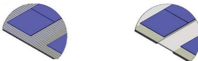
**Abb. 3: Prinzipielle Aufbauvarianten: links WÜ vollflächig auf gesamtem PV-Modul und rechts WÜ partiell (nur unter Wavern)**
