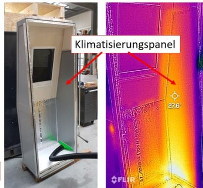
Klimatisierungserprobung aufheizen, links Wärmeverteilung von außen, rechts Wärmeverteilung von innen
