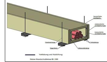
Kabel- und Installationskanäle verkleidung mit SUHITEMPIN-Platter
