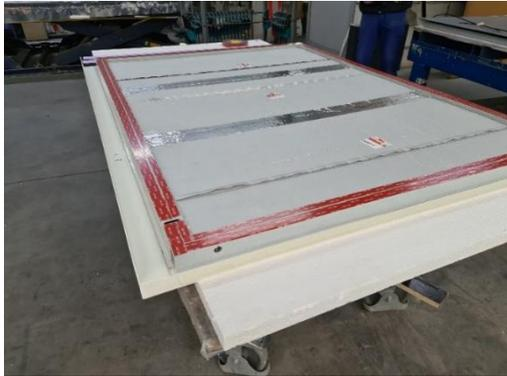
GFK-Unterkonstruktion mit integrierten VIP
