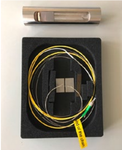
Abb. 7: Lichtwellenleiter mit Messgitter und spannungsfreie Messgitteraufnahme zur Temperaturkompensation eines integrierten Drucksensors
