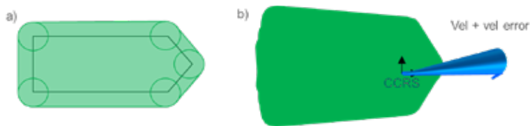
Abb. 3: a) sichere Schiffskontur unter Berücksichtigung des horizontalen Protection Levels und b) zusätzlicher Berücksichtigung des Heading-Fehlers
