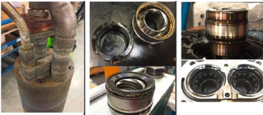
Abb. 5: Inspektion des MDA nach 1000 Betriebsstunden
