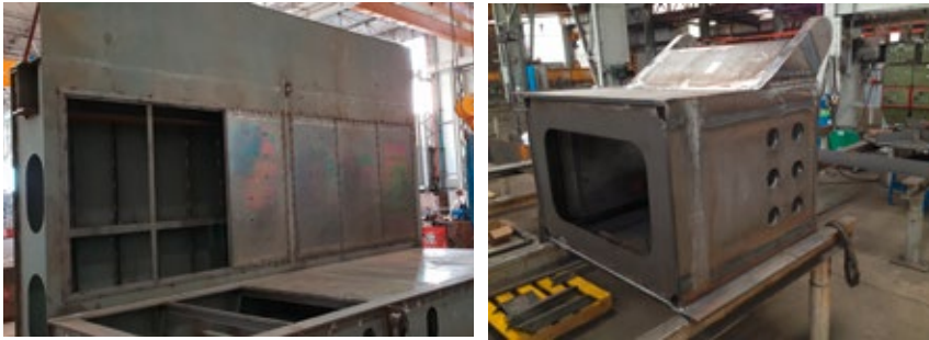
Abb. 10: Demonstratorbau zum Nachweis der technischen Realisierbarkeit der entwickelten Konzeptlösungen (links: Schiffssektion, rechts: Brückenträger)
