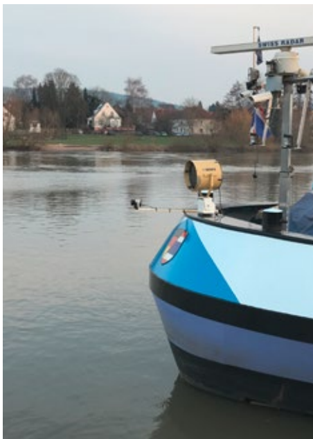
Abb. 8: Montage Laserscanner an einem Erprobungsschiff
