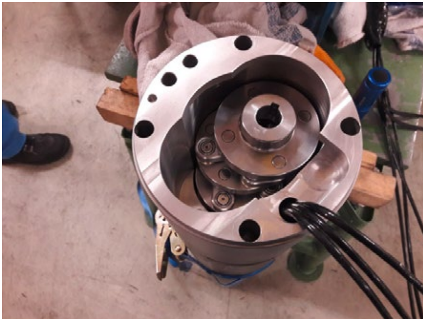
Abb. 3: Kupplung zum Ausgleich des Wellenversatzes
