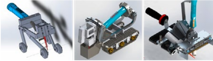
Abb. 9: Evolutionsstufen des Shiplight-Handsweißgerätes für verschiedene Fügeanordnungen (Quelle: Fraunhofer IAPT)
