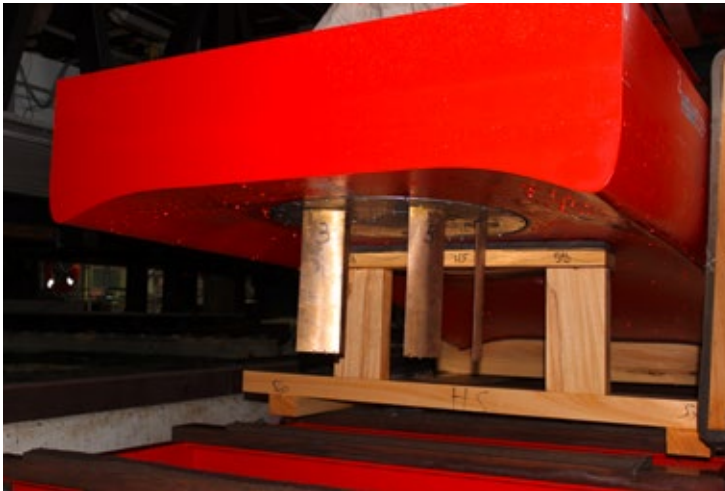
Abb. 20: Modell-VSP ( D=400 mm) in einem zur kontrollierten Zuführung von Eisschollen konzipierten Schiffsmodell.
