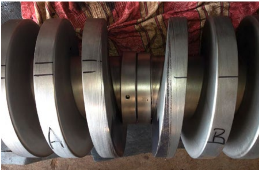
Abb. 6: Rotor mit kombinierten Korrosions- und Erosionsverschleiß
