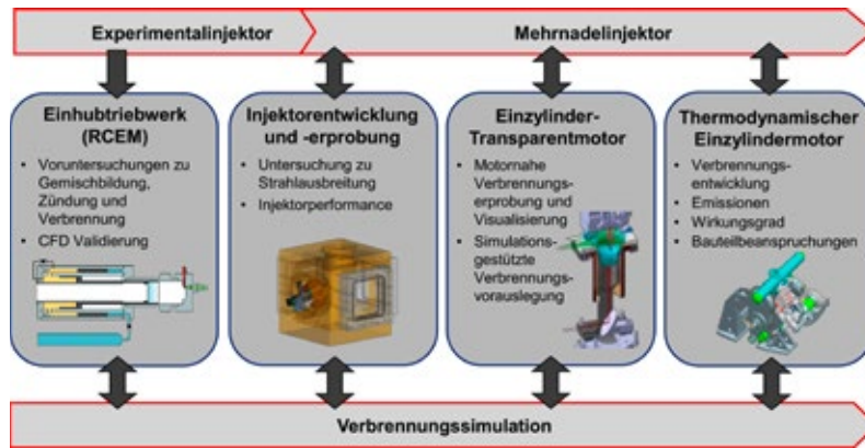
Abb. 2: Vorgehensweise zur HPDF Motorkonzeptentwicklung
