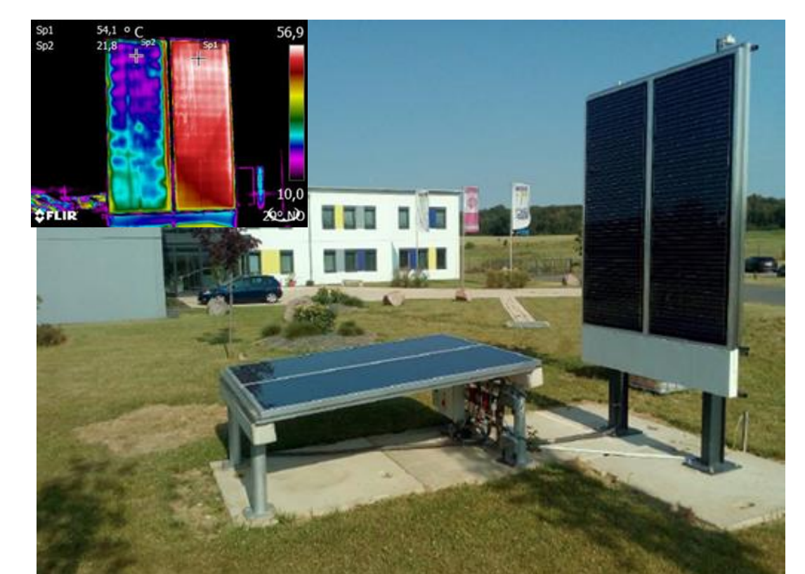
Multifunktionales energieeffizientes Dach- und Fassaden-Solarelement
